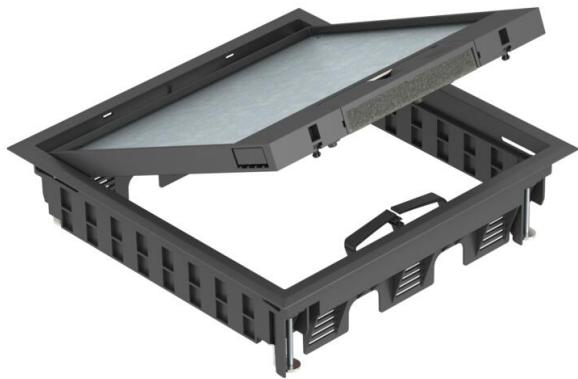
Torretta a scomparsa con maniglia ed uscita cavi orientabile con guarnizione in materiale espanso. Il coperchio incernierato è dotato di una piastra di rinforzo strutturale in lamiera d'acciaio con spessore di 4 mm e permette l'installazione di un rivestimento pavimento di 5 mm (regolabile anche a 10 mm). È possibile anche utilizzare fino a 3 prese tipo CEE.
