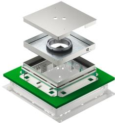
Cassetta quadrata livellabile sospesa per il montaggio a filo pavimento per scatole massetto UGD55 250 (profondità minima di installazione 136 mm) / UZD 250 (profondità minima di installazione 151 mm). Adatta per pavimenti in cemento.
