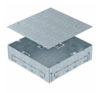
Scatola per massetto quadrata per GES9-2, per l'utilizzo in pavimenti flottanti e/o massetto in ambienti interni. Con aperture preforate per tubi (M25) su tutti i lati.
