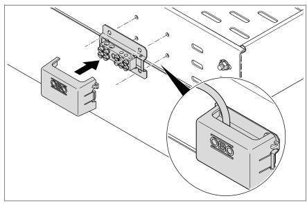
Figure 11: Mounting of the equipotential busbar
