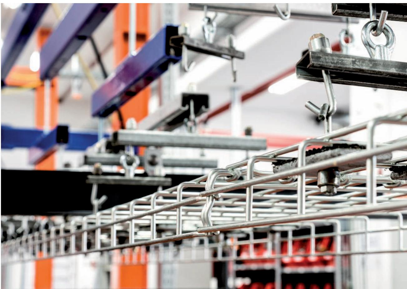
Il laboratorio di prova per il KTS è stato costruito specificamente per eseguire test sui sistemi di passerelle portacavi di OBO Betterman. Grazie al suo sviluppo continuo e all'adattamento agli standard più
